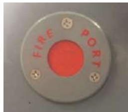
Feuerlöschöffnung auf der Backbordseite der Konsole
